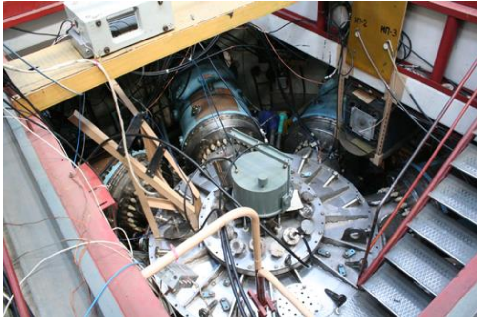
Рисунок 4.2. Сборка импульсного генератора тока с вакуумной камерой генератора Ангара-5-1. 1 – крышка вакуумной камеры генератора Ангара-5-1; 2 – ИГТ; 3 – опоры; 4 – НПЛ.
