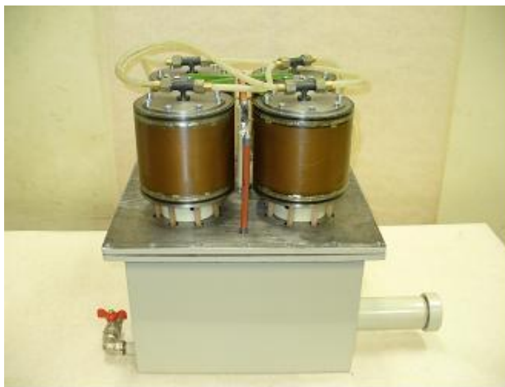
Рисунок 3.1. Общий вид импульсного генератора. В верхней части этого рисунка показана компоновка четырех ККС, в нижней части бак, в котором размещаются ККС.
