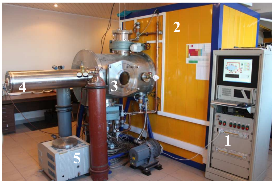
Рисунок 2.1. Фотография экспериментального стенда. 1 - блок управления вакуумной системой и разрядами, 2 - высоковольтный терминал, 3 - вакуумная камера, 4 - времяпролетный спектрометр, 5 - система «безмасляной» откачки.
