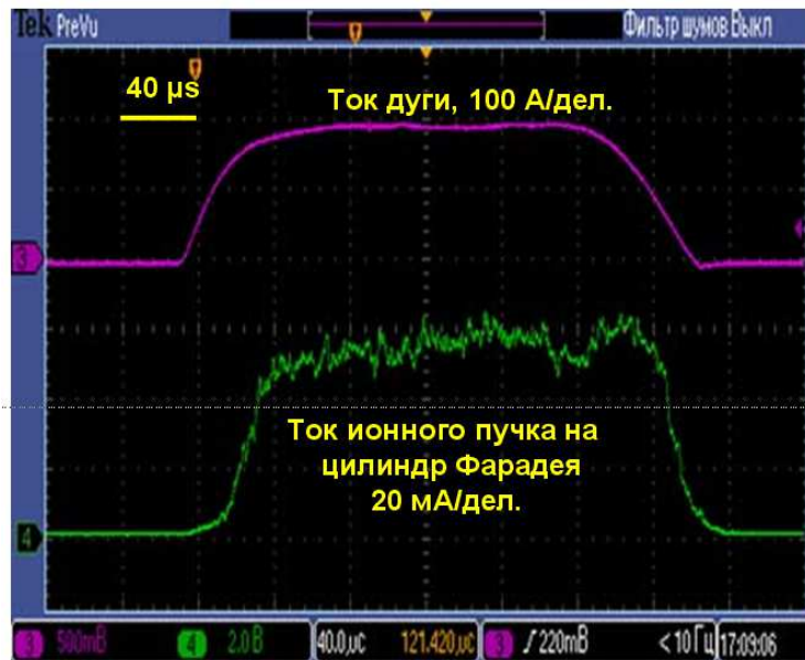
Рисунок 3.2. Импульс тока вакуумной дуги и ионного тока на цилиндр Фарадея. Усреднение по 4 импульсам. Полный ток ионного пучка – 400 мА. Ускоряющее напряжение – 20 кВ. Давление – 4 \cdot 10^{-6} Торр.
