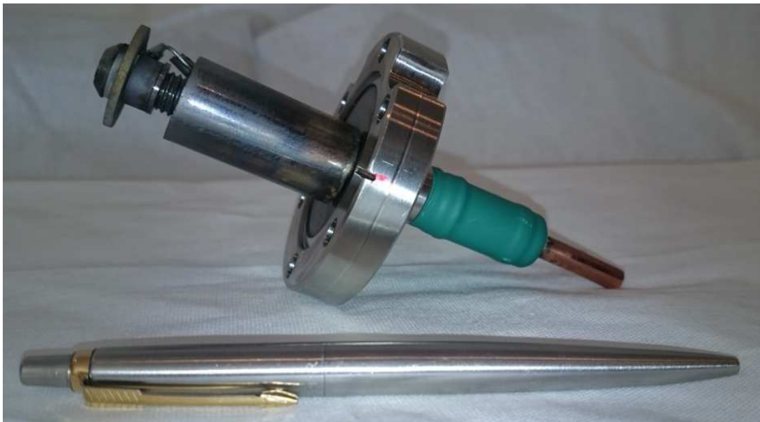
Рисунок 3.4. Катодный узел вакуумной дуговой разрядной системы короткой длительности импульса с катодом из дейтерида циркония.
