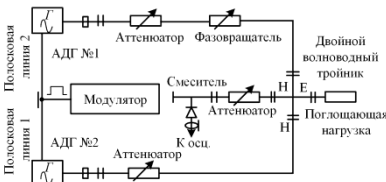
Рисунок 14 – Схема измерений стандартного отклонения разности фаз \sigma_{\delta t} СВЧ-колебаний двух наносекундных генераторов Ганна трехсантиметрового диапазона методом измерения амплитуды суммарного детектированного сигнала
