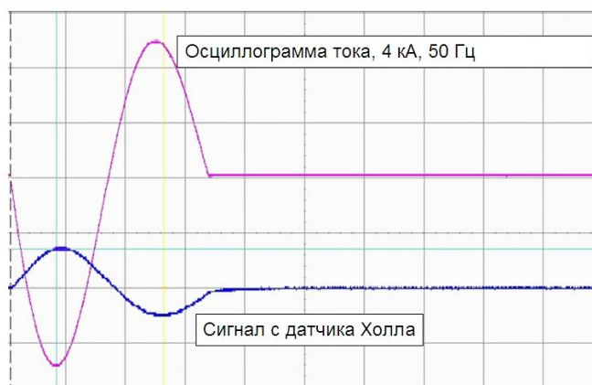
Рисунок 3.2. – Пример набора осциллограмм при измерении магнитного поля в разрядном промежутке при амплитуде тока 4 кА на первой полуволне.
