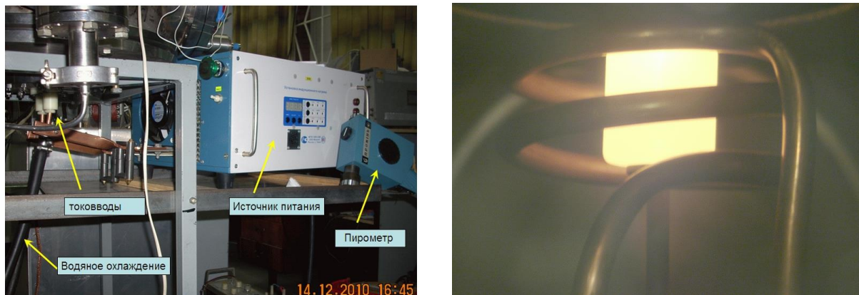
Рисунок 3.6. – Источник питания индуктора, пирометр и фотография разогретого тигля.
